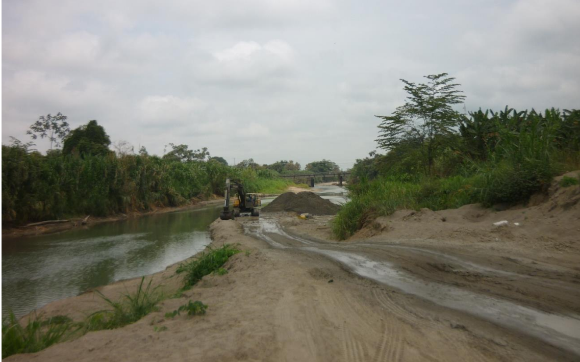
Foto 7. Plataforma de acceso al área minera, formada del retiro de la arena del cauce y que sirve para que accedan los volquetes a retirar el material.
