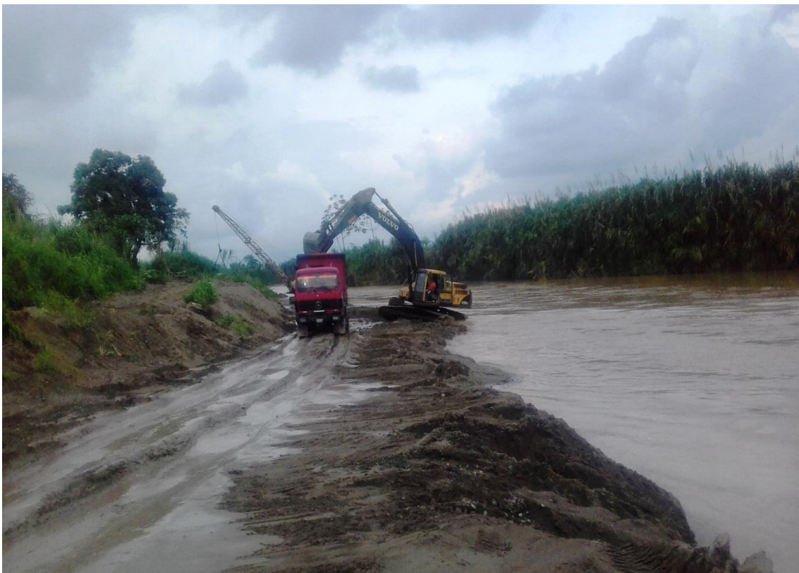
Foto 6. El método de extracción consiste en dragar del centro del río, colocar el material por donde transitan los volquetes para ir por toda la concesión minera. El apilamiento del material es temporal, este es retirado de forma inmediata por los volquetes del titular minero.
